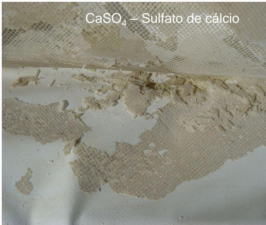
**Correção:** pH alto e limpeza com EDTA (difícil)
